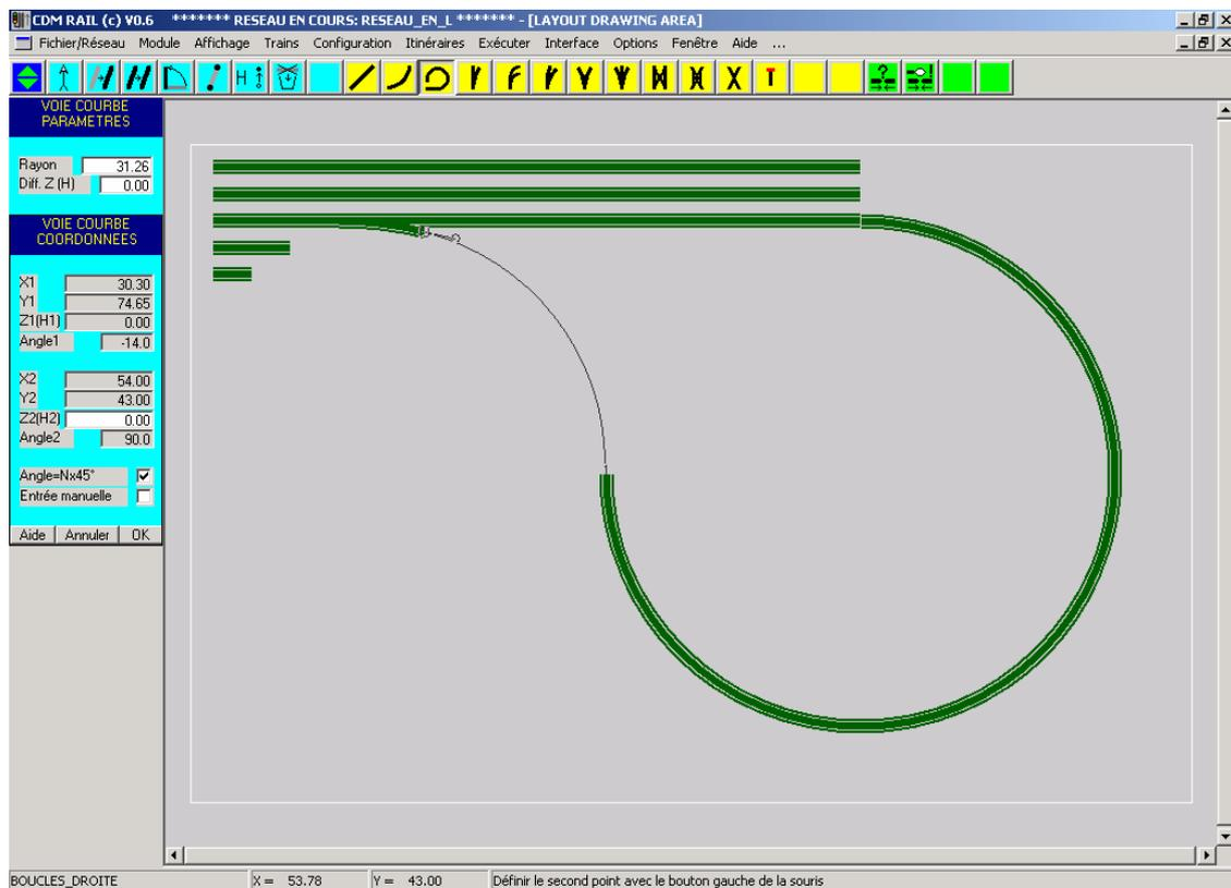
**Figure MM-3-10: fermeture de la boucle interne par segment en courbe.**
