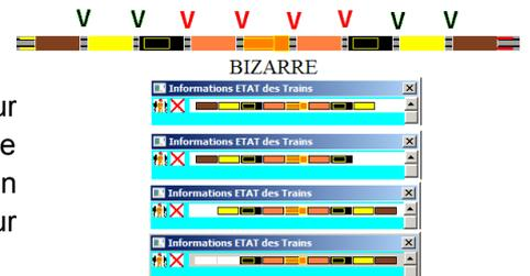
Cette composition hétéroclite de 9 éléments dont 3 sont moteurs, n'a pour but que de montrer là où elle peut être sectionnée, avec l'affichage correspondant. Les positions rouges sont interdites et de toute façon inaccessibles. La section débranchée est toujours affichée en couleur "fantôme". La position s'ajuste par Clic et DoubleClic (\*\*\*)
